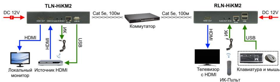
Рис.8 Схема подключения комплекта TLN-HiKM2+RLN-HiKM2 в режиме «точка-точка» через коммутатор
