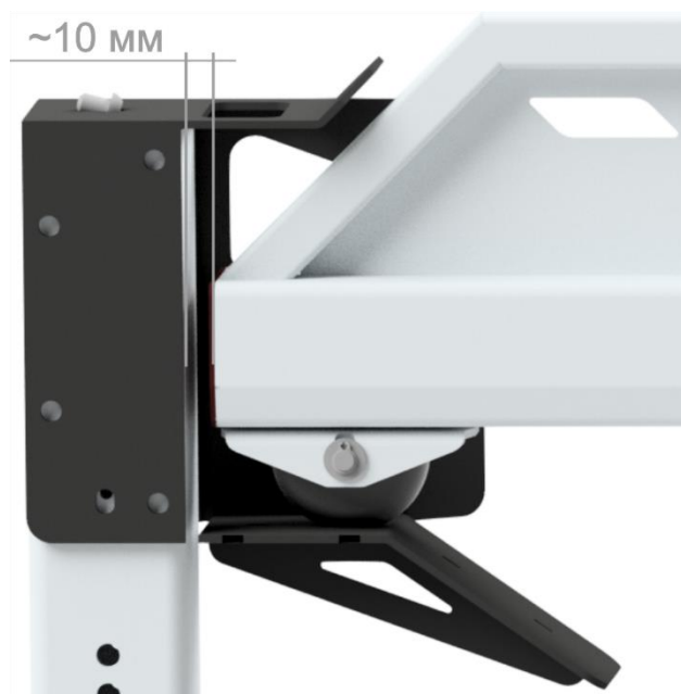
Рисунок 2-15 Правильное положение стрелы на стрелоуловителе
