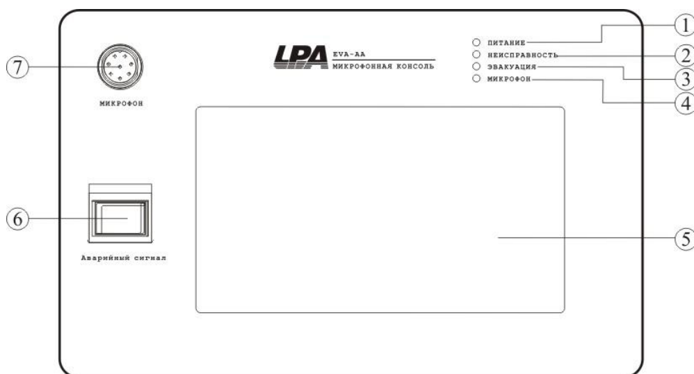
Рис. 2.2. Лицевая панель удаленной микрофонной консоли LPA-EVA-AA
