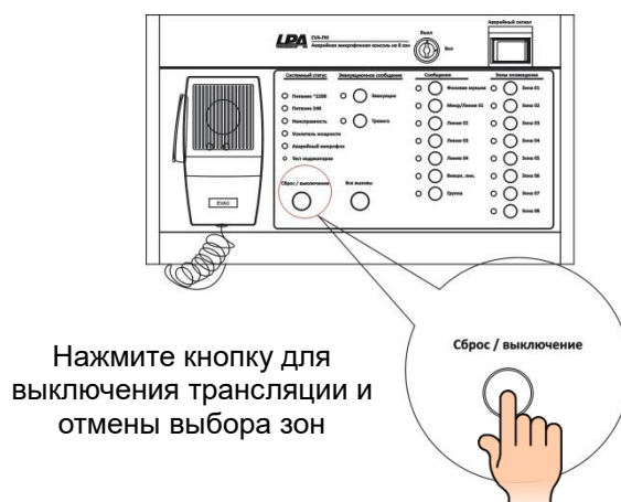
Рис. 4.3. Отмена выбора зон на микрофонной консоли LPA-EVA-FM
