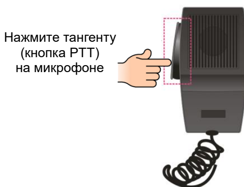
Рис. 4.2. Включение тангентного микрофона консоли LPA-EVA-FM
