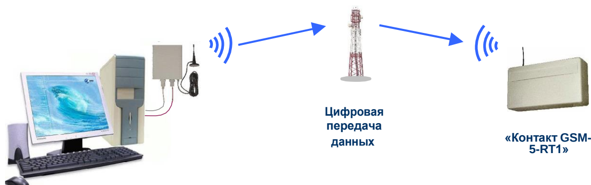
Рис.5.3. Подключение «Контакта GSM-5-RT1» к компьютеру через цифровое соединение сотовой сети.
