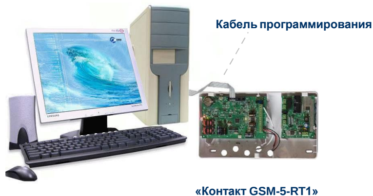
Рис.5.1. Подключение «Контакта GSM-5-RT1» к компьютеру через кабель программирования.
