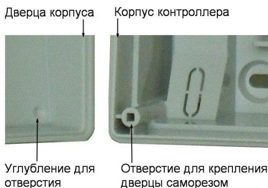
Рисунок 4. Схема «жесткого» крепления дверцы к корпусу контроллера
