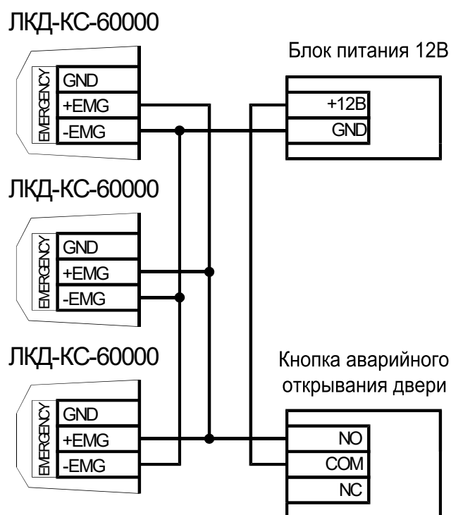
Рисунок 27. Схема подключения одной аварийной кнопки к нескольким контроллерам
