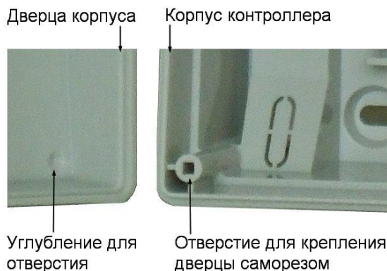
Рисунок 5. Схема «жесткого» крепления дверцы к корпусу контроллера
