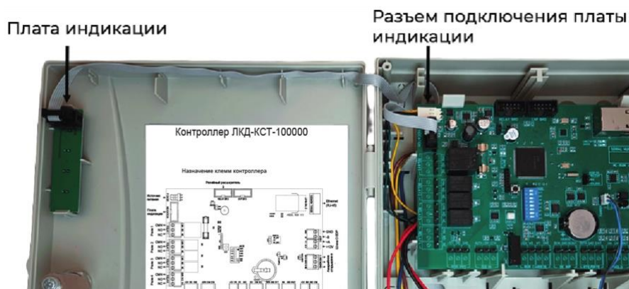
Рисунок 27. Подключение платы внешней индикации
