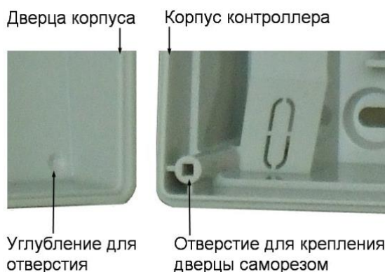
Рисунок 4. Схема «жесткого» крепления дверцы к корпусу контроллера
