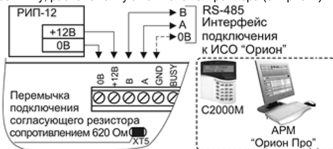
Рисунок 4. Схема подключения по интерфейсу RS-485
