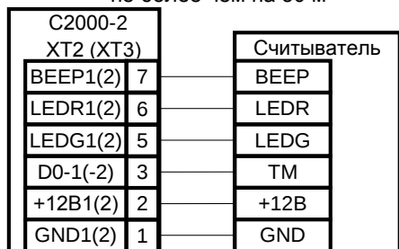
Рисунок 11. Схема подключения считывателей с интерфейсом Touch Memory
