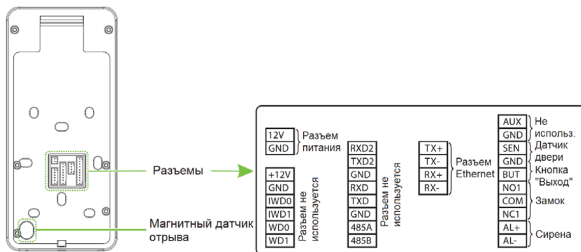
Рисунок 4. Схема расположения разъемов
