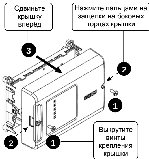
Рисунок 2. Снятие крышки контроллера
