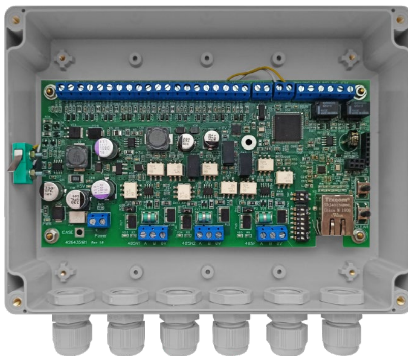
Рисунок 1. Внешний вид контроллера «Заря-КЛС» со снятой крышкой.
