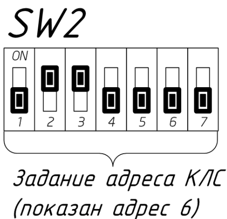
Рисунок 3. Пример установки адреса контроллера переключателями SW2
