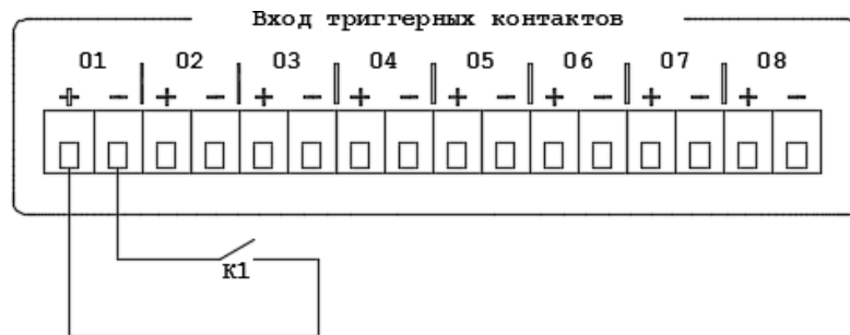
Рис. 2.3. Схема подключения внешних сигналов управления к LPA-DUO без контроля целостности.
