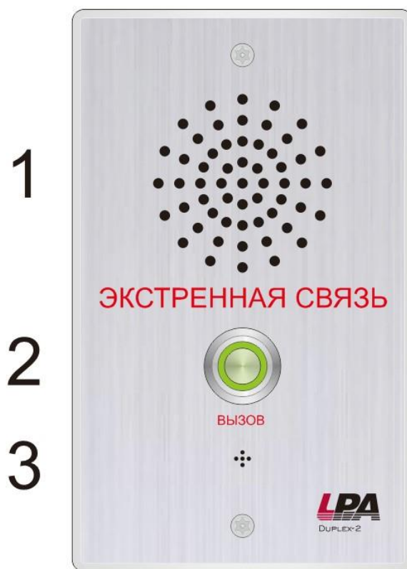
Рис. 3.3 Передняя панель вызывной панели
