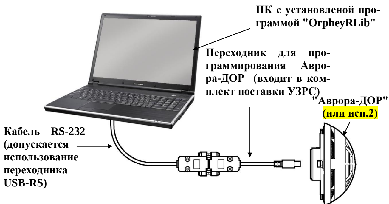
Рисунок В.24 – Подключение ПК для программирования речевых сообщений в устройство "Аврора-ДОР"
