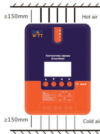
Рисунок 2-1. Установка и рассеивание тепла
