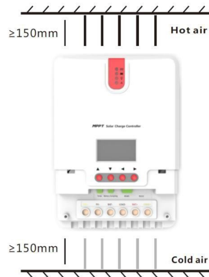
Рисунок 2-1. Установка и рассеивание тепла
