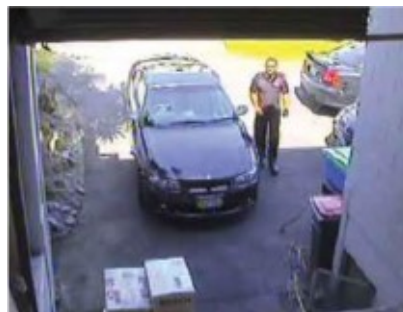
Режим WDR включен. Объекты видны отчетливо.
