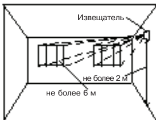
Рис. 28-Установка извещателя на противоположной стене
