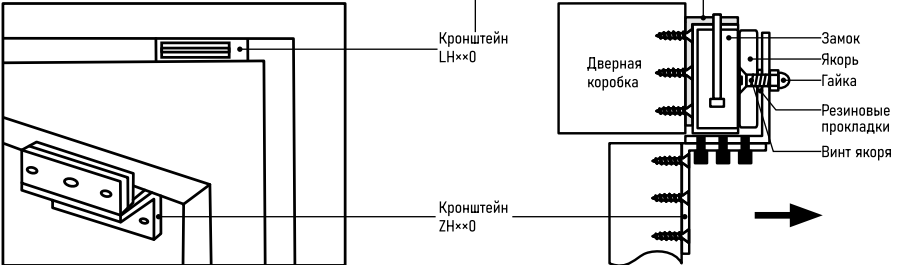
Рис. 2 Монтаж с помощью кронштейна L и Z-типов
