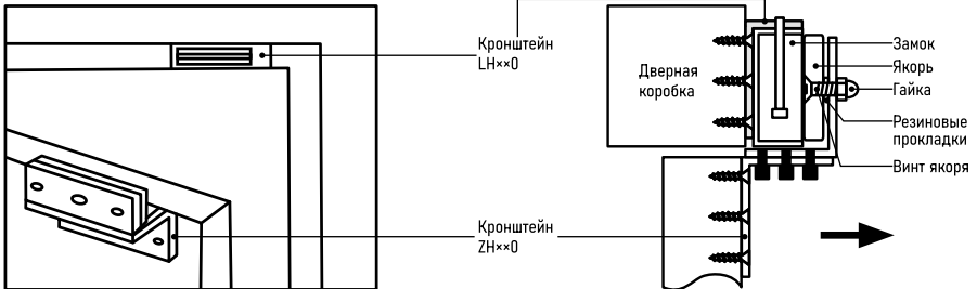
Рис. 2 Монтаж с помощью кронштейна L и Z-типов
