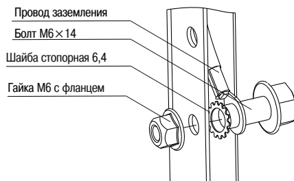
Рисунок 20 – Узел заземления на стойках
