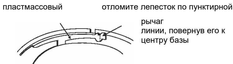
Рис. 1 Активация функции защиты от несанкционированного извлечения извещателя
