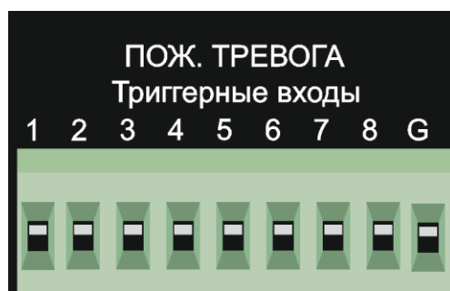
Рис.3.3. Внешний вид клеммной колодки.
