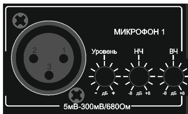
Рис.3.4. Область настроек входа МИКРОФОН 1
