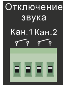
Рис.2.9. Входы отключения трансляции
