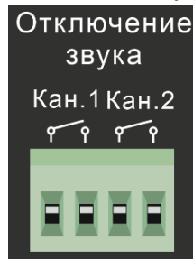
Рис.2.9. Входы отключения трансляции
