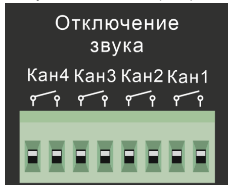
Рис.2.9. Входы отключения трансляции
