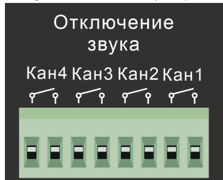
Рис.2.9. Входы отключения трансляции
