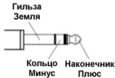
Рис. 4.1. Назначение контактов штекера TRS jack 6.35 мм
