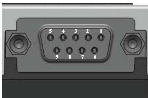
Рисунок 6: Выводы RS-232 (D-Sub 9-контактный)
