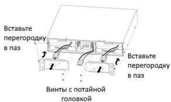
Рисунок 5-3. Установка новых аккумуляторных батарей
