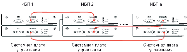
Рисунок 34 – Схема подключения нескольких системных шасси в параллельный режим
