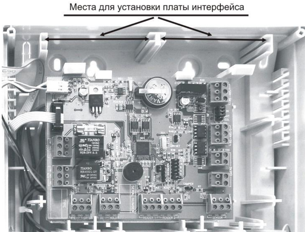
Рисунок 3. Места установки платы ЛКД-МКС-02 в корпусе контроллера
