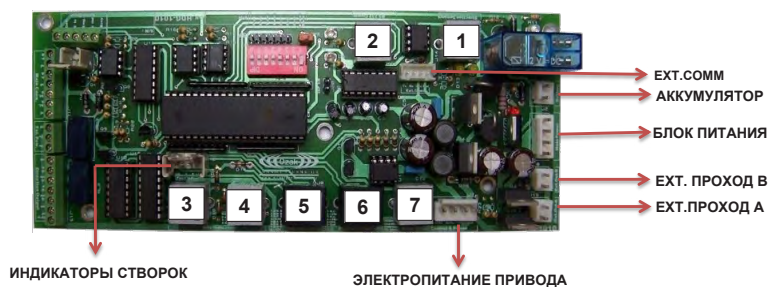
ОСНОВНАЯ ПЛАТА УПРАВЛЕНИЯ HDG-2010
