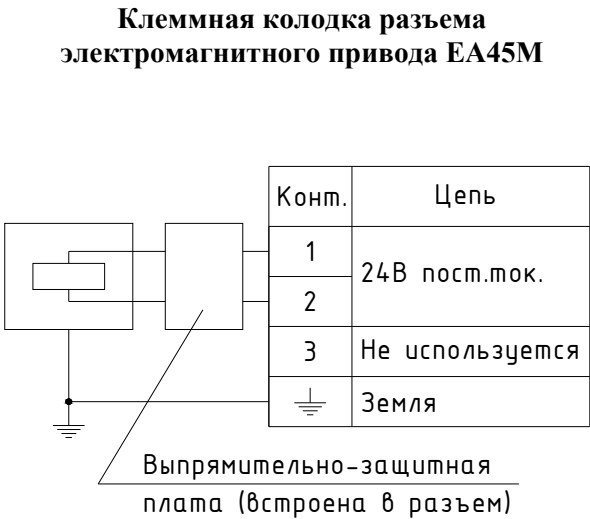
Рисунок 3б. Электрическая схема расключения разъема электромагнитного привода
