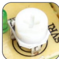
Возможность корректировки выходного напряжения
