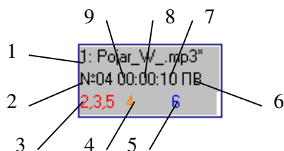
Рисунок 7.22. Вершина графа. 1 – номер звукового файла, 2 – порядковый номер вершины, 3 – перечень линий эвакуационного оповещения, 4 – перечень линий предупредительного оповещения, 5 – перечень выключаемых линий, 6 – требование привлечения внимания, 9:8:7 – часы:минуты:секунды времени нахождения алгоритма в этом состоянии.
