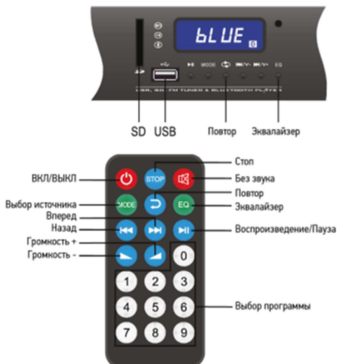
Рис. 3. Внешний вид пульта управления и модуля проигрывателя, расположенного на передней панели Тромбон МУ-XXX
