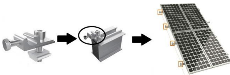
Рисунок 34. Установка зажима заземления.
