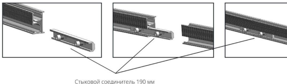
Рисунок 19. Соединение двух и более профилей с помощью стыкового соединителя.
