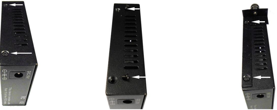
Рис. 4 Установка крепления под винт на корпус медиаконвертера
