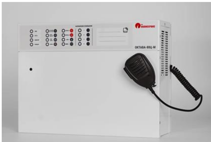
Рисунок 3.7 - Фиксация внешнего микрофона ВМ-03 на крышке ППУ
