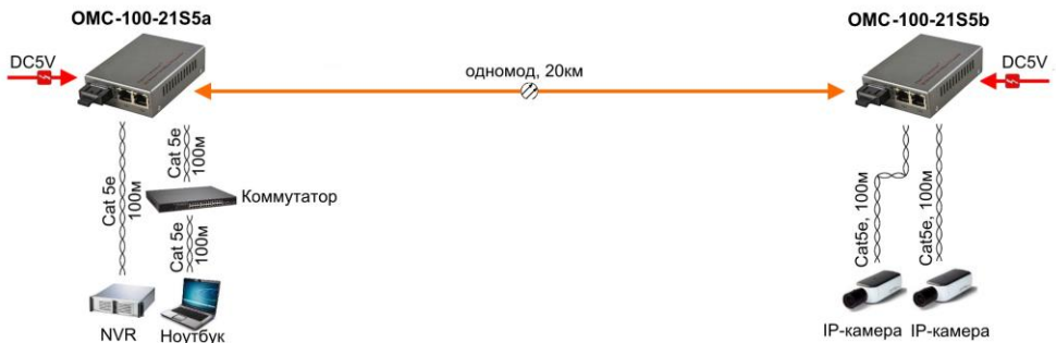
Рис. 7 Схема подключения медиаконвертеров OMC-100-21S5a (OMC-100-21S5b)
