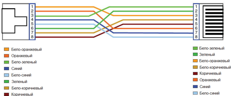
Рис. 9 Обжимка кабеля по типу TIA/EIA-568-B.
