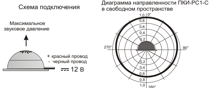
Рис.2 Схема подключения и диаграмма направленности звука оповещателя.
