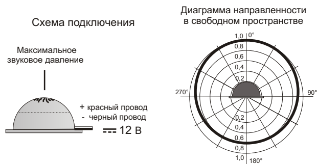
Рис.2 Схема подключения и диаграмма направленности звука оповещателя.
