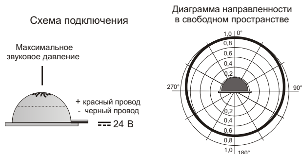
Рис.2 Схема подключения и диаграмма направленности звука оповещателя.
