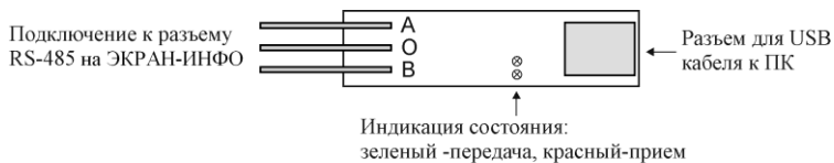
Рисунок 6. Расположение контактов преобразователя ПИ1.
