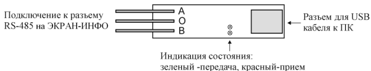
Рисунок 6. Расположение контактов преобразователя ПИ1.
