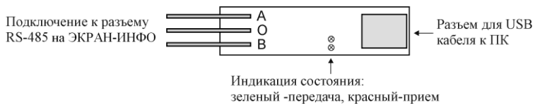
Рисунок 6. Расположение контактов преобразователя ПИ1.
