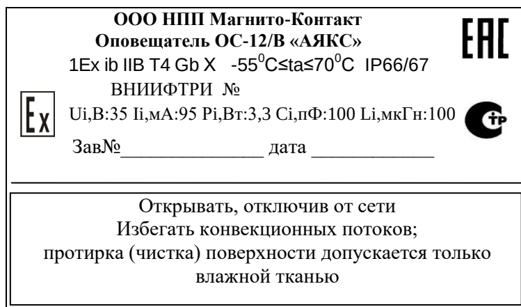
Рис. 1 Маркировка оповещателя ОС-12/В «АЯКС»
