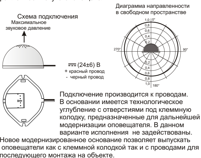
Рис.2 Схема подключения и диаграмма направленности оповещателя.
